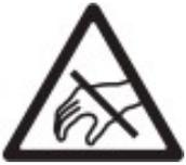
LED-Lampen sind leicht anfällig für ESD (elektrostatische Entladung) und Beschädigungen. Bitte berühren Sie die Lampe nicht.
